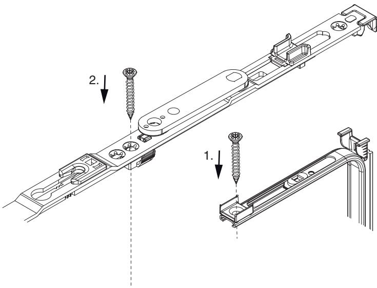
Zuerst Eckumlenkung senkrecht einsetzen und in den Nutgrund verschrauben (1), danach Scherenstulp in Eckumlenkung einklippen und verschrauben (2).
