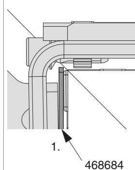
1. Bei der Seiteneinstellung der Scheren bis Version 2 ist die Verwendung der Fühlerlehre Art. Nr. 468684 zwingend vorgeschrieben, um das minimale Einstellmaß nicht zu unterschreiten!
