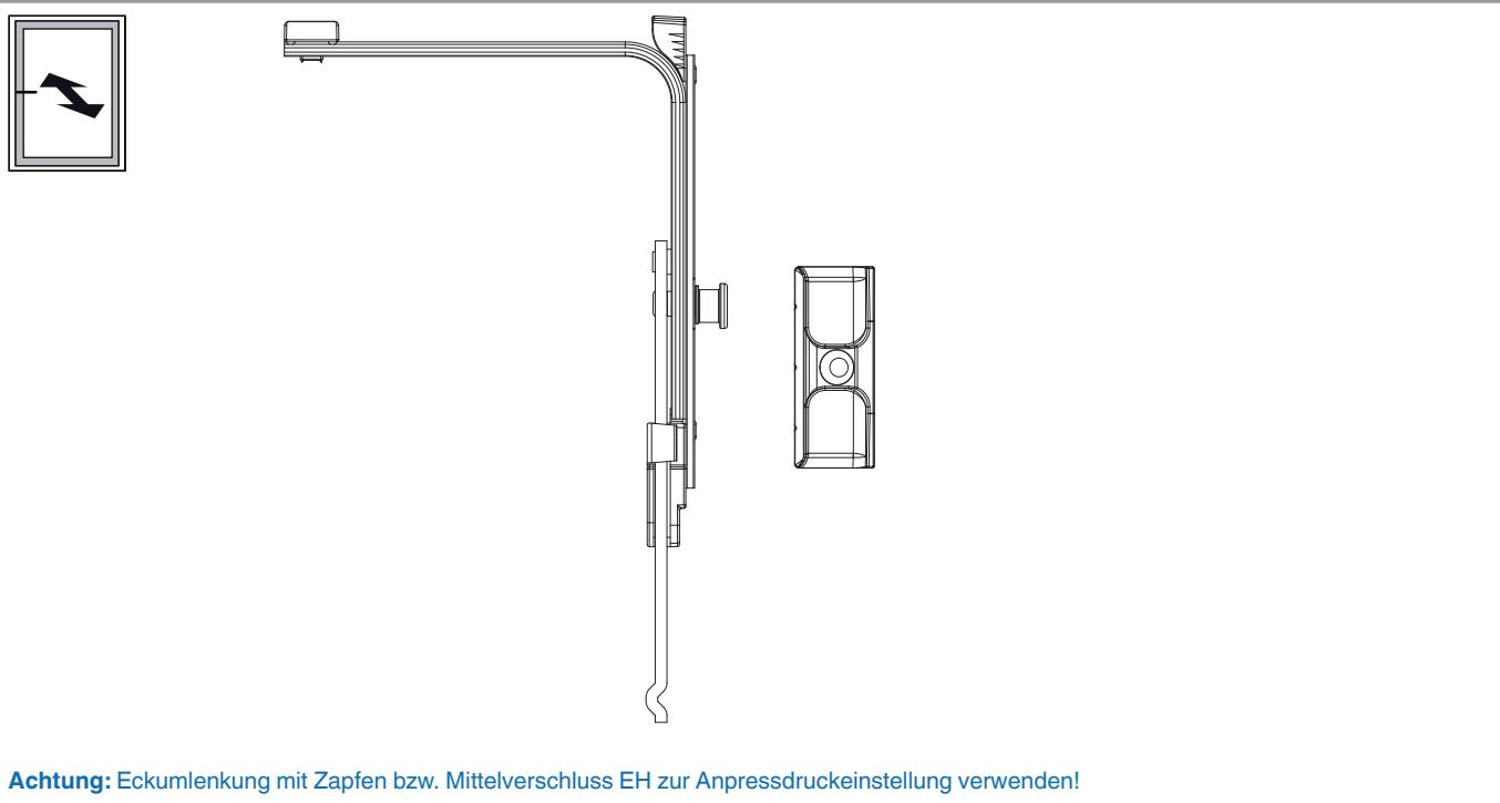
Achtung: Eckumlenkung mit Zapfen bzw. Mittelverschluss EH zur Anpressdruckeinstellung verwenden!
