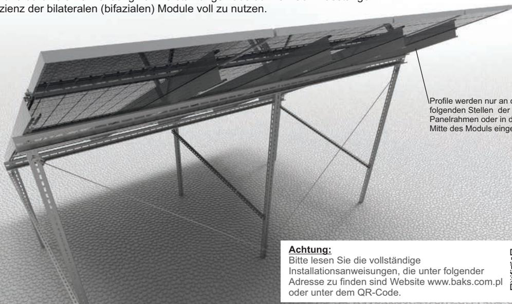
Profile werden nur an den folgenden Stellen der Panelrahmen oder in der Mitte des Moduls eingesetzt
