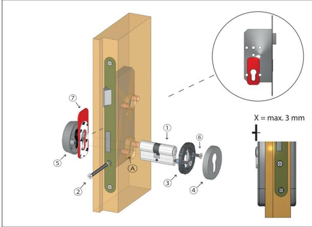
Zur Markierung der Schraublöcher die Grundrosette über den Profilzylinder schieben. Die zu bohrenden Löcher von beiden Seiten anzeichnen.
