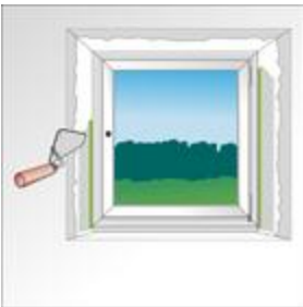
Bild 13: Einputzen und glattstreichen
