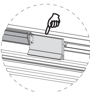
7.) Ersatzdichtung im Flügel einsetzen
