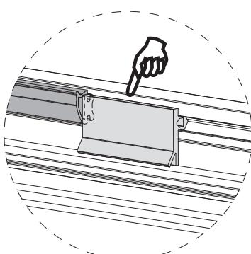
**7.) Ersatzdichtung im Flügel einsetzen**
