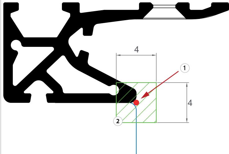
Die Position von KU-Dichtschiene und Dichtungsplatte (1, roter Punkt) muss sich im grünen Toleranzfeld (2) befinden.
