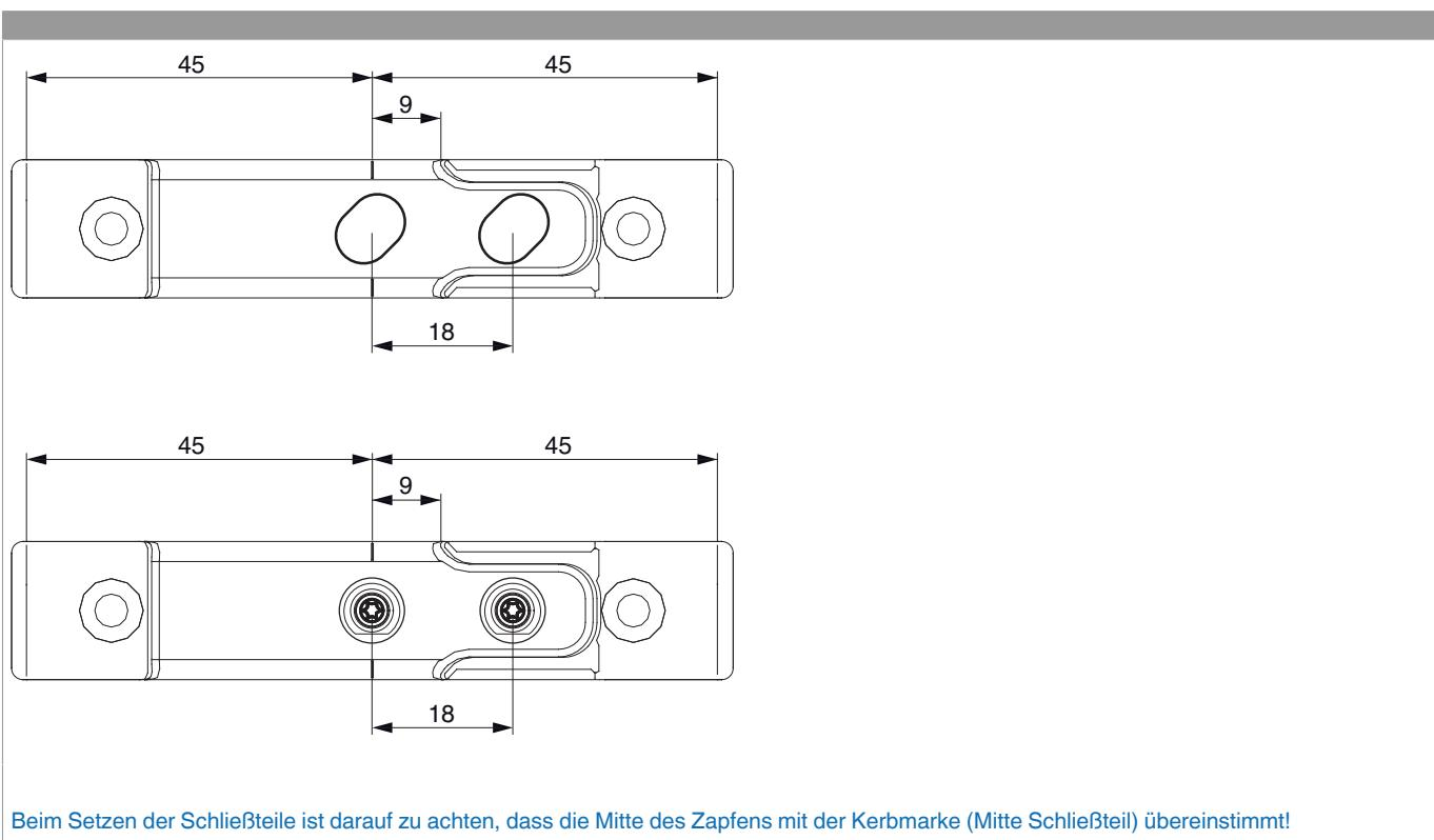
Beim Setzen der Schließteile ist darauf zu achten, dass die Mitte des Zapfens mit der Kerbmarke (Mitte Schließteil) übereinstimmt!
