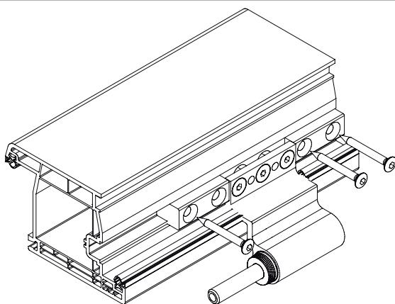
Flügelteil einsetzen und mit Inbusschlüssel SW4 verschrauben (je nach Profilaufbau 3-7 Nm). Dichtung auf Flügelteil im Bereich der unterbrochenen Dichtebene aufkleben.
