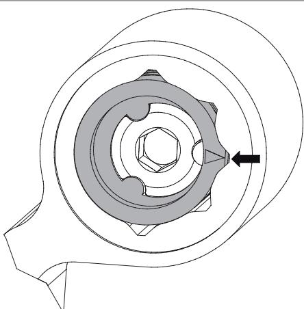
Exzenterbuchse in Nullstellung (Inbuss SW4).
