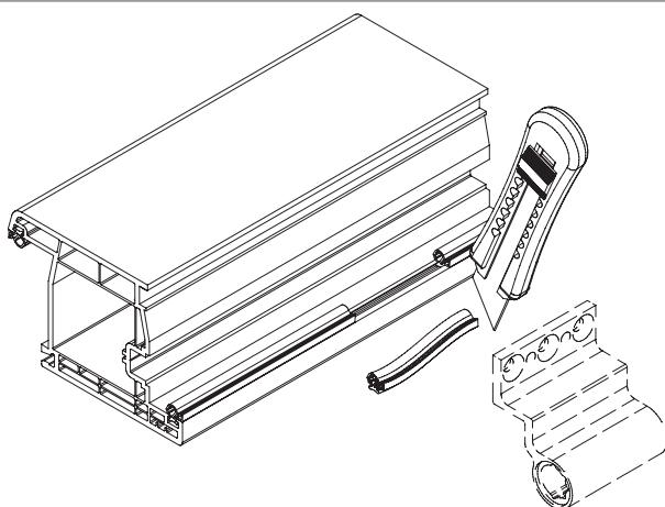
Anschlagdichtung am Flügel unter Band zurückschneiden.
