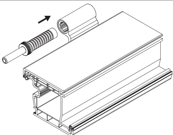
Exzenterbuchse mit vormontierten Tragring und Achse mit Gummihammer in Flügelteil einschlagen.
