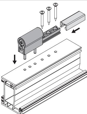
Rahmenteil einsetzen und mit Inbusschlüssel SW4 verschrauben (je nach Profilaufbau 3-7 Nm).
