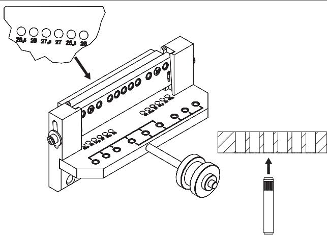
Je nach Profil den richtigen Abstand zur Positionierung der Zylinderstifte aus der Tabelle auswählen. Zylinderstifte auf beiden Seiten der Bohrlehre von unten eindrücken.
