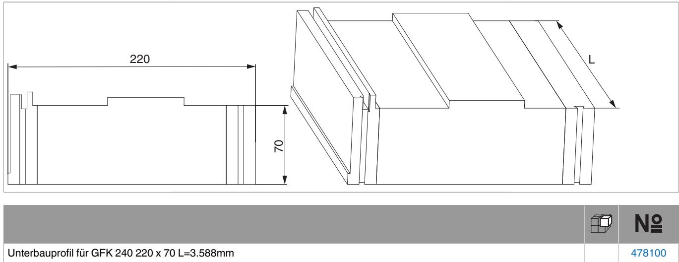
Unterbauprofil für GFK 240 220 x 70 L=3.588mm
