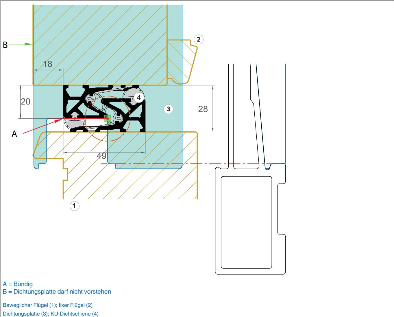
Positionierung von KU-Dichtschiene und Dichtungsplatte für optimale Entwässerung
