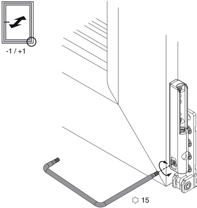
• **Einstellung:** Weiters kann mit dem TX15, Art. Nr. 43647, der Anpressdruck eingestellt werden.
