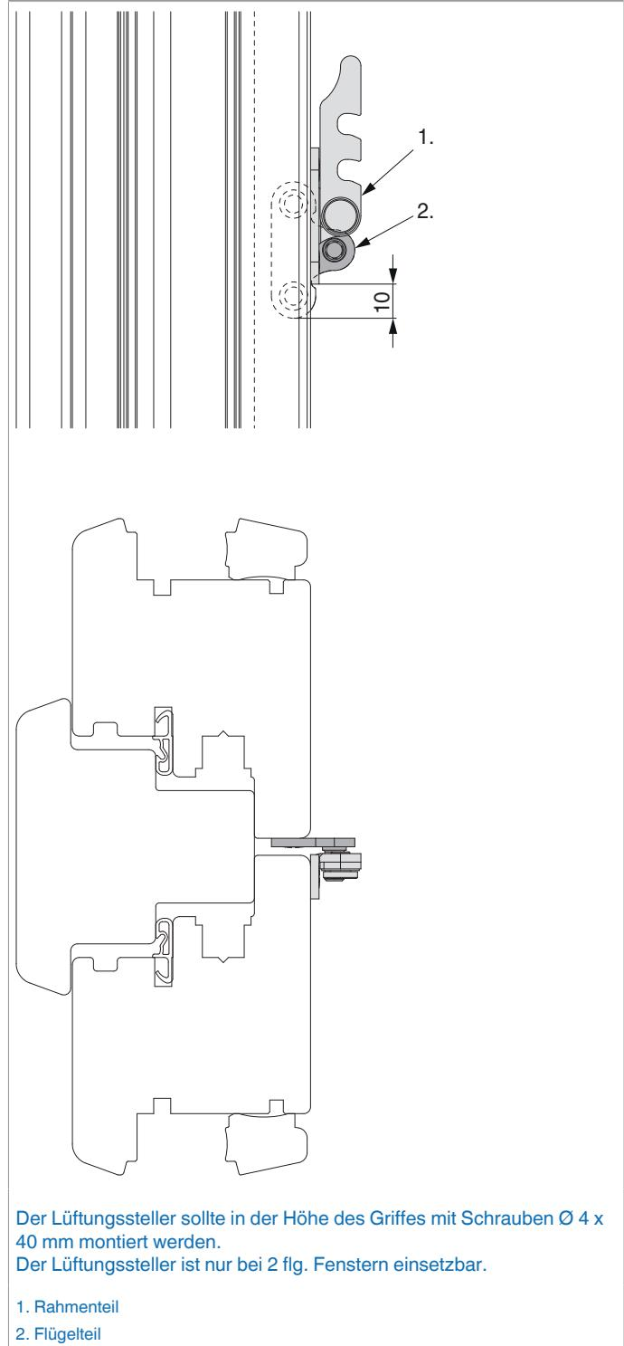
Der Lüftungssteller sollte in der Höhe des Griffes mit Schrauben Ø 4 x 40 mm montiert werden.
