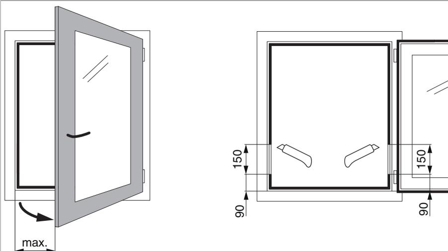
1.) Anschlagdichtung am Blendrahmen ausnehmen
