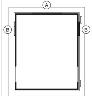
(A) Einbaulage Fensterfalzventil horizontal (ohne Feder): Möglichst immer paarweise und möglichst mittig
