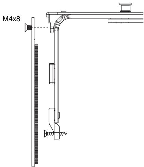
**WICHTIG** - Nutgrundverschraubung vor Stützbockverschraubung
