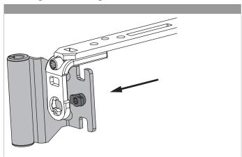
Den Bandwinkel auf die montierte Schere von hinten auf den Tragebügel aufstecken (bei ausgeschwenktem Scherenarm oder Drehlagerarm).
