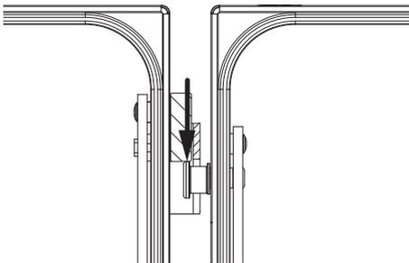
Wenn der Spreizhebel beim Einbruchversuch von außen geöffnet werden soll, drückt der Sperrschieber auf den i.S. Zapfen und verhindert somit ein Öffnen.
