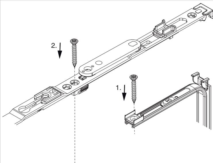
Zuerst Eckumlenkung senkrecht einsetzen und in den Nutgrund verschrauben (1), danach Scherenstulp in Eckumlenkung einklipsen und verschrauben (2).
