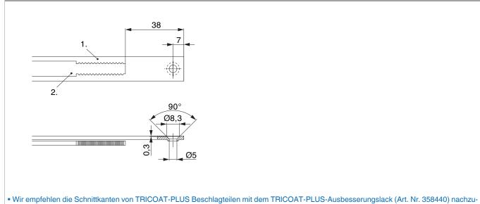
Wir empfehlen die Schnittkanten von TRICOAT-PLUS Beschlagteilen mit dem TRICOAT-PLUS-Ausbesserungslack (Art. Nr. 358440) nachzubehandeln.
