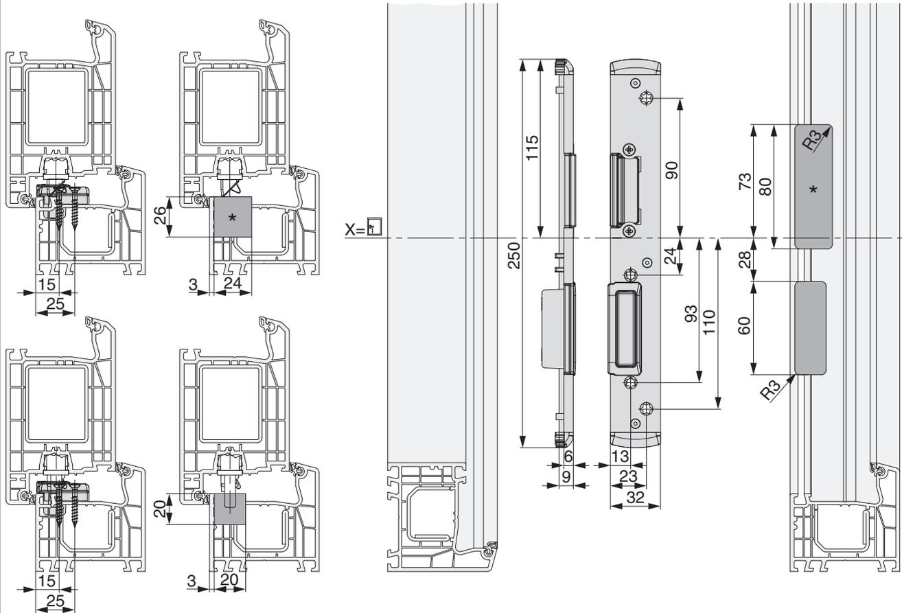
\* Fräsung wird nur bei Verwendung eines E-Öffners benötigt.
