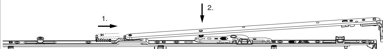
1. Scherenarm mit Gleitschlitten in den Scherenstulp einschieben
