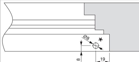
• Auflagedübel muss bei Holz ab 100 kg Flügelgewicht verwendet werden!
