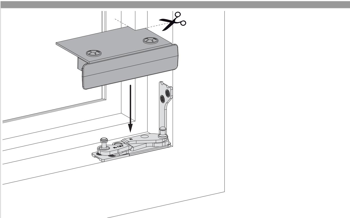
2. Schmutzabdeckung zuschneiden und auf die beiden Ecklagerbolzen aufdrücken bis zum Einrasten.
