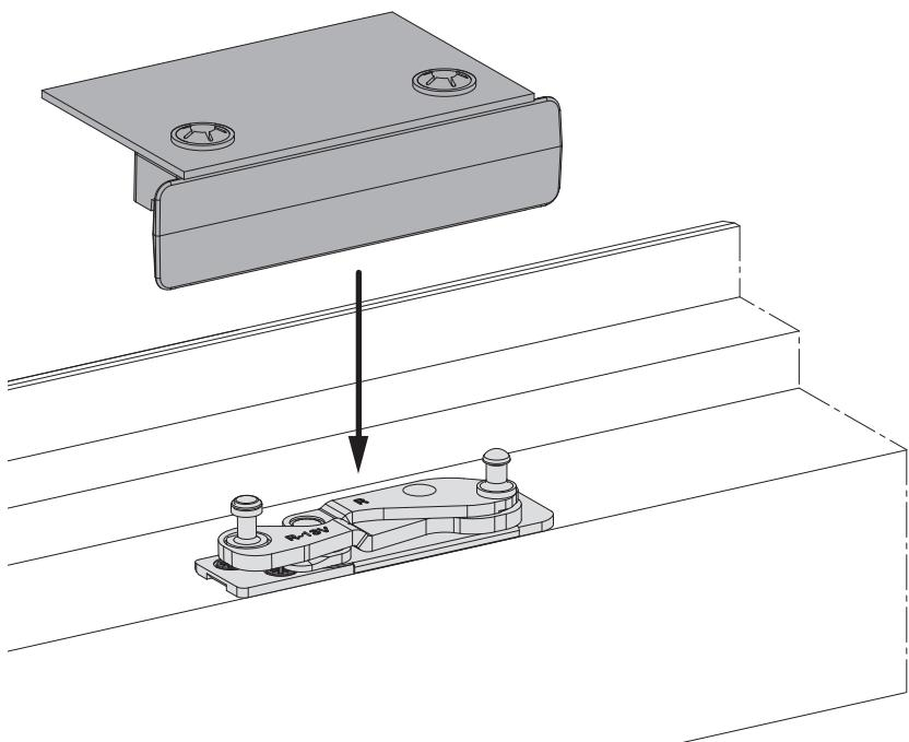
2. Schmutzabdeckung auf die beiden Ecklagerbolzen aufdrücken bis zum Einrasten.
