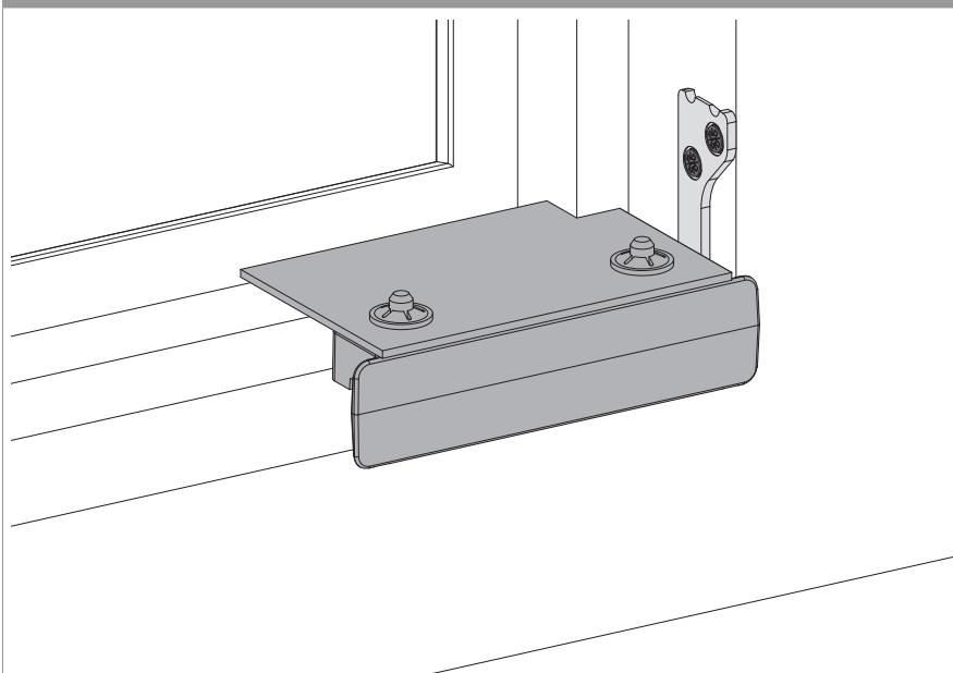
3. Schmutzabdeckung im montierten Zustand.
