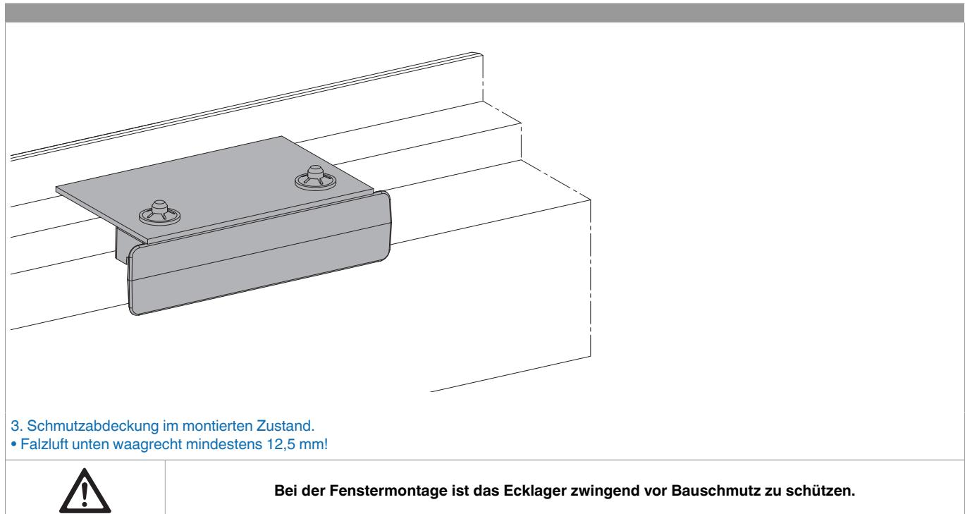
3. Schmutzabdeckung im montierten Zustand.
