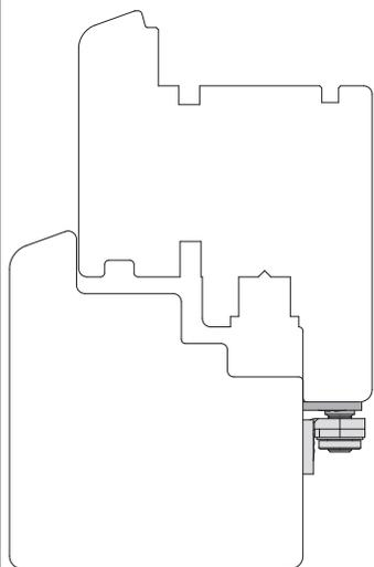
Der Lüftungssteller sollte in der Höhe des Griffes mit Schrauben  $\text{Ø } 4 \times 40 \text{ mm}$  montiert werden.
