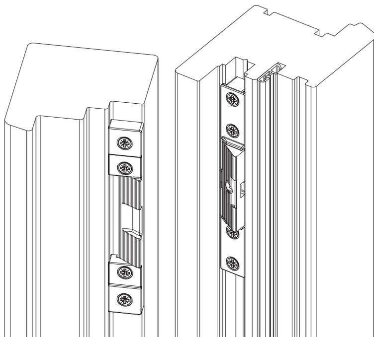
Flügelteil in Beschlagnut einsetzen, positionieren (mittig Rahmenteil) und verschrauben.
