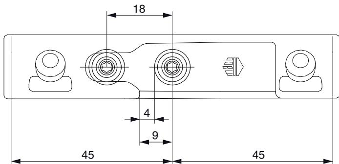
Bei geprüfter Einbruchhemmung ist der Abstand Schließteil - Zapfen auf 2 mm zu verringern.
