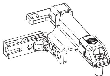
1. Scherenlagerstiftsicherung bis zum Anschlag aufschieben.
