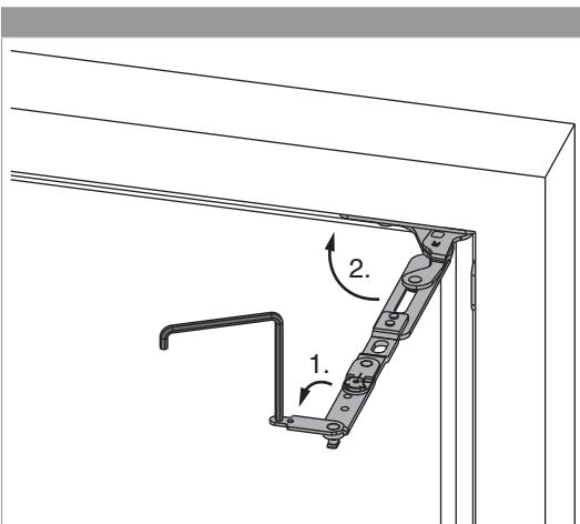
1. Drehbandarmsicherung mit Inbusschlüssel SW 4 öffnen.
