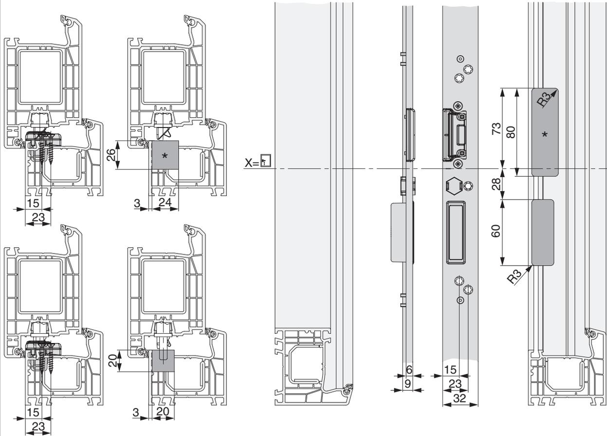
\* Fräsung wird nur bei Verwendung eines E-Öffners benötigt.
