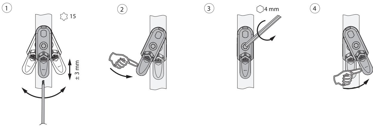
1. Ausschwenken und Höhenverstellung der Hebesicherung.
