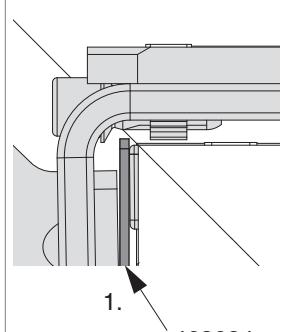
1. Bei der Seiteneinstellung der Scheren bis Version 2 ist die Verwendung der Fühlerlehre Art. Nr. 468684 zwingend vorgeschrieben, um das minimale Einstellmaß nicht zu unterschreiten!
