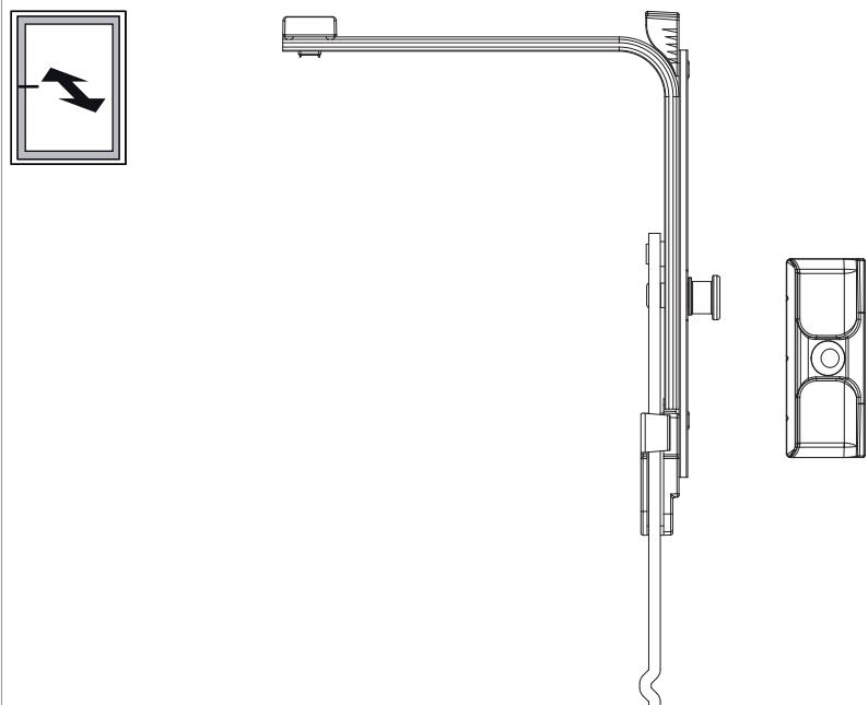
**Achtung:** Eckumlenkung mit Zapfen bzw. Mittelverschluss EH zur Anpressdruckeinstellung verwenden!
