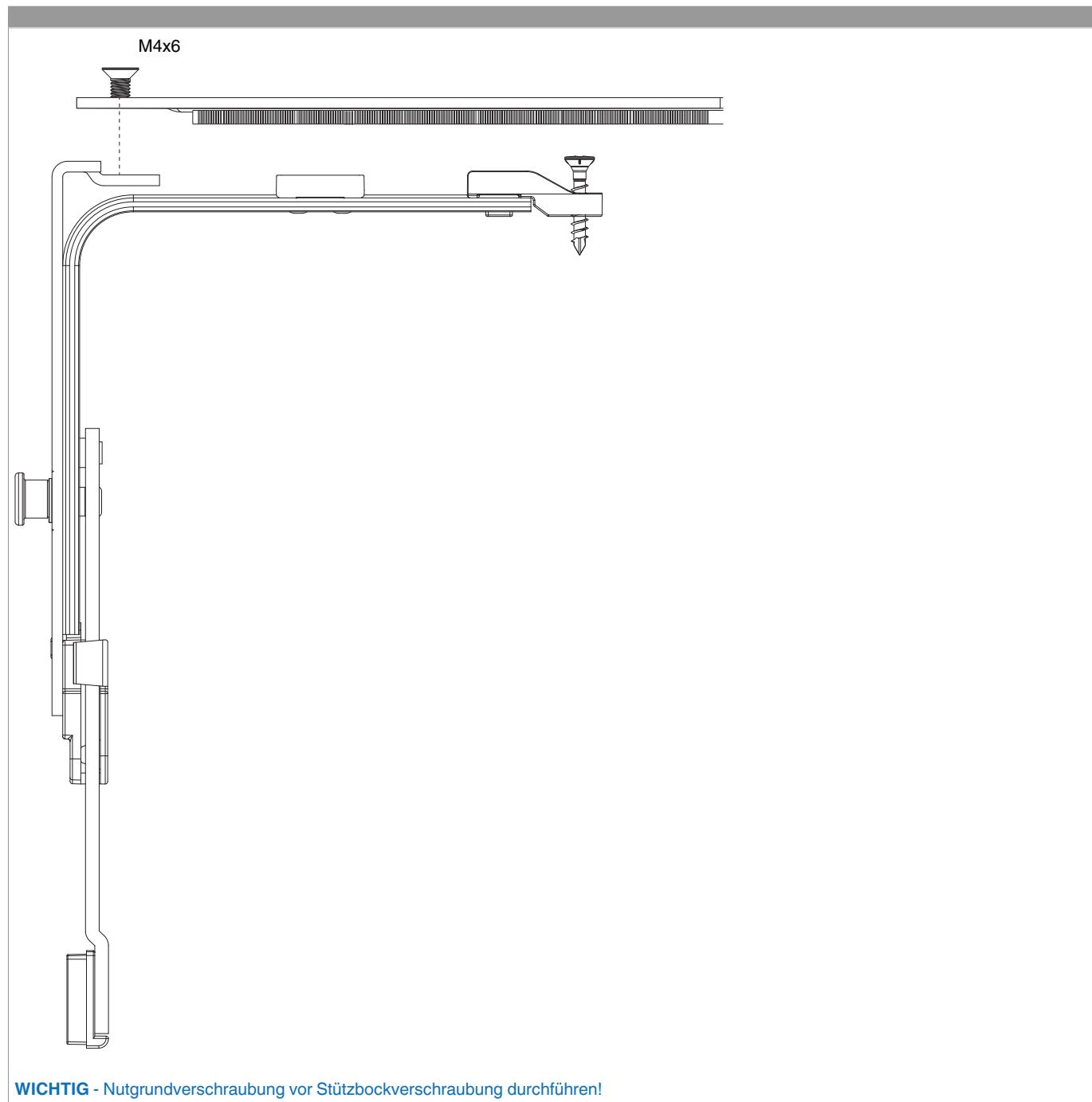
**WICHTIG** - Nutgrundverschraubung vor Stützbockverschraubung durchführen!
