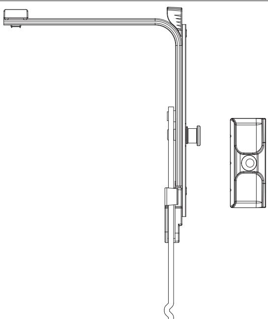
Achtung: Eckumlenkung mit Zapfen bzw. Mittelverschluss EH zur Anpressdruckeinstellung verwenden!
