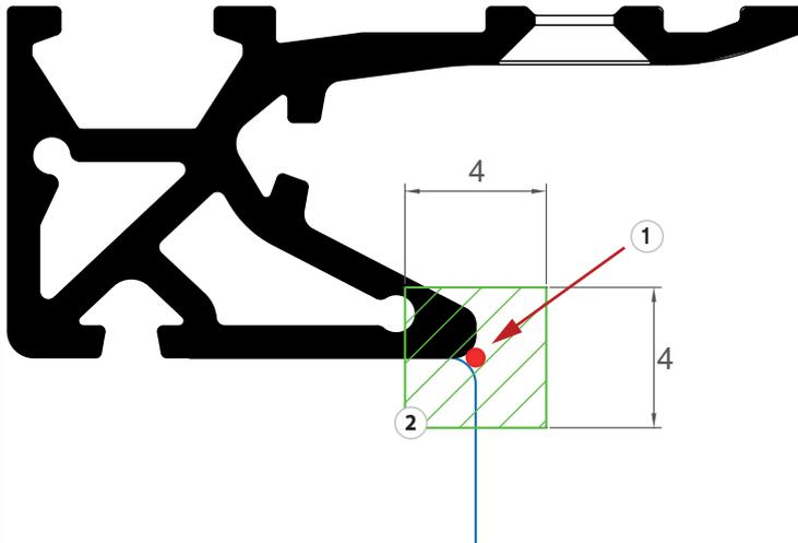
Die Position von KU-Dichtschiene und Dichtungsplatte (1, roter Punkt) muss sich im grünen Toleranzfeld befinden (2).
