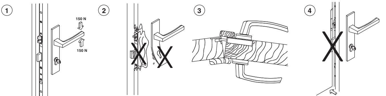
1) Drücker nur im normalen Drehsinn belasten! In Betätigungsrichtung (auf den Drücker) max. eine Kraft von 150 N aufbringen!
