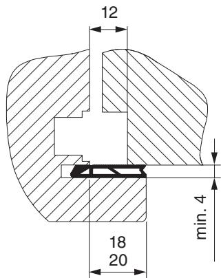
1. Bei Fenstern ohne Überschlagdichtung ist eine Fräsen am Überschlag notwendig!
