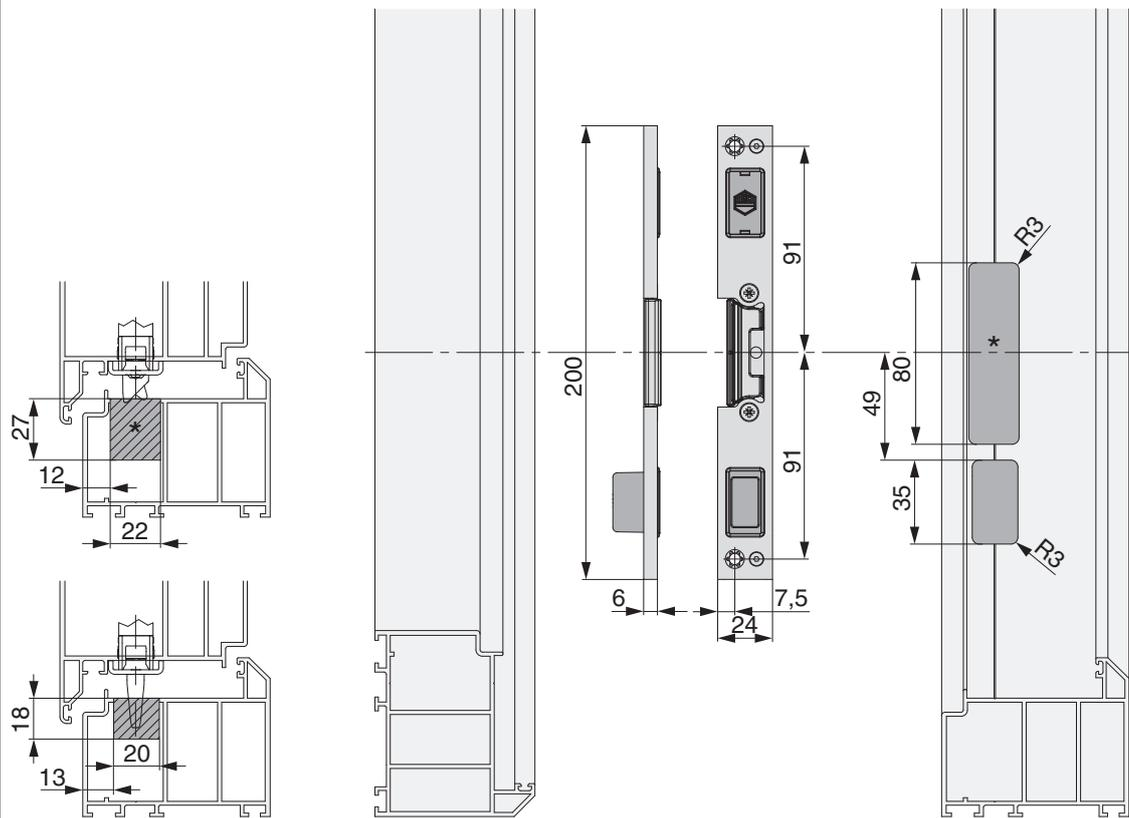
\* Fräsung wird nur bei Verwendung eines E-Öffners benötigt.
