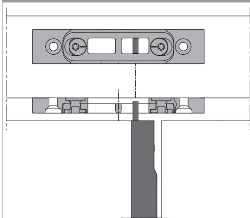
Mitte Stangenausschluss auf Kerbe ausrichten
