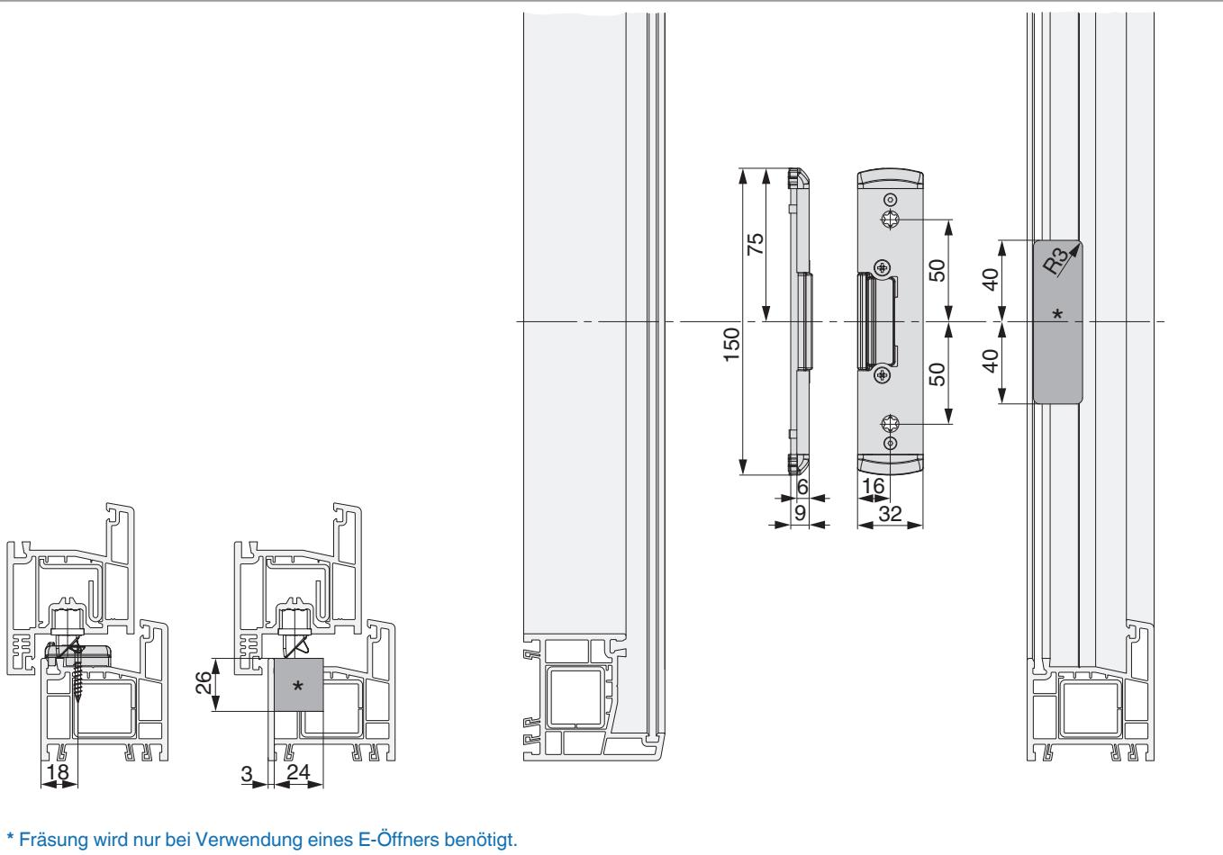
\* Fräzung wird nur bei Verwendung eines E-Öffners benötigt.
