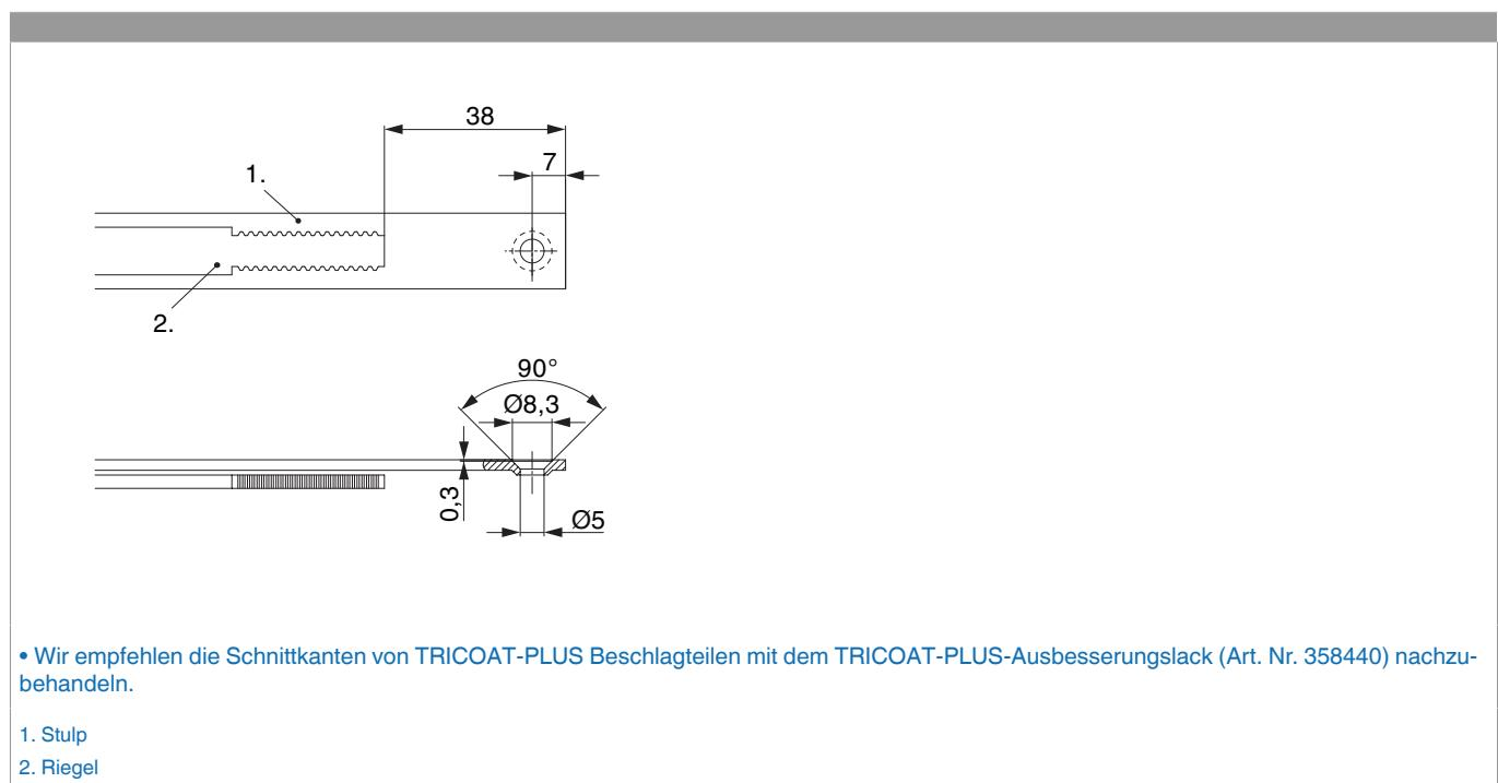
• Wir empfehlen die Schnittkanten von TRICOAT-PLUS Beschlagteilen mit dem TRICOAT-PLUS-Ausbesserungslack (Art. Nr. 358440) nachzubehandeln.
