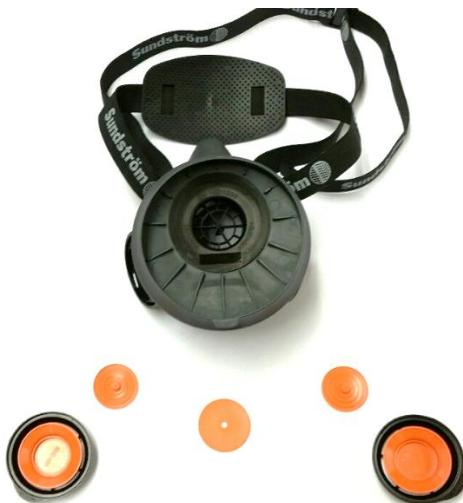
Filter und Membrane entfernen.
