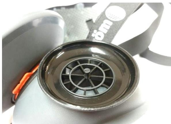
Kritische Bereiche sind die Ausatmungsmembrane und die Ventilsitze, die saubere und unbeschädigte Kontaktflächen haben müssen.
