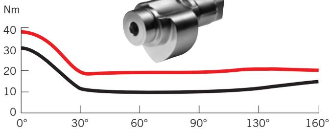
Die herzförmige Nockenscheibe und der Lineartrieb des TS 97 sorgen für eine leichte Betätigung der Tür durch ein stark abfallendes Öffnungsmoment. So haben selbst Kinder, alte Menschen und Behinderte keine Mühe mehr, Türen zu öffnen.
