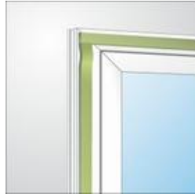
Bild 1: Eckauslegung bei der Fenstermontage
