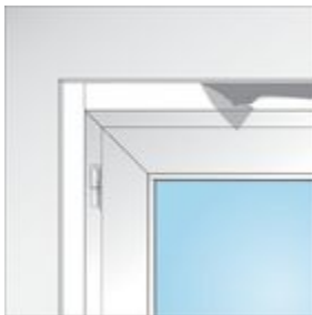
Bild 4: Die Leisten werden stumpf gestoßen.
