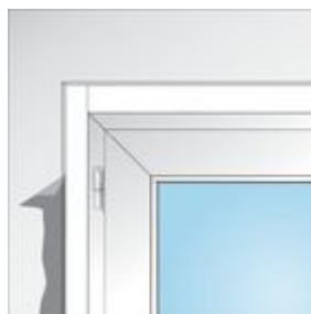
Bild 3: Das Fugen-Dichtband kann dekomprimieren und dichtet somit die Fuge zwischen Mauerwerk und Fenster ab.
