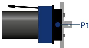
Bevor der blaugelb Funk-Handsender 15 verwendet kann, muss dieser einmalig mit dem jeweiligen Rollladenmotor gekoppelt werden.
