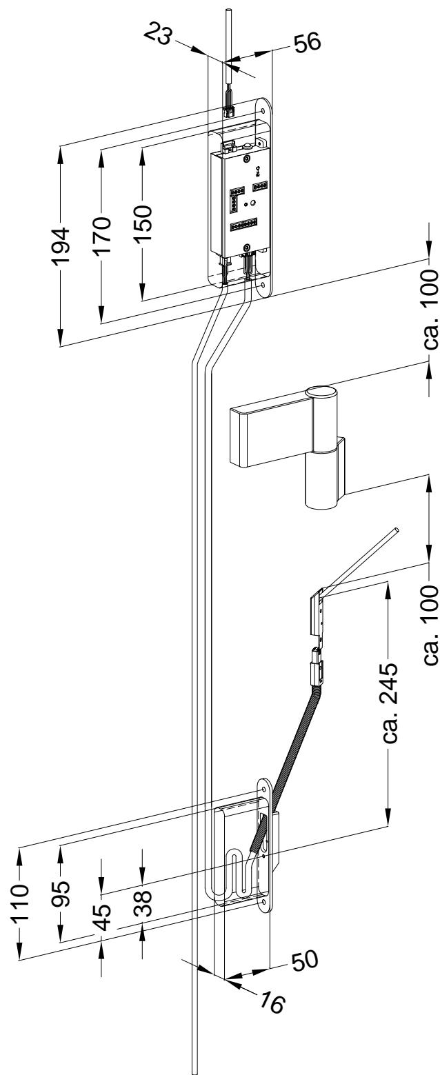
Hinweis: Empfohlen wird die Positionierung von Gehäuse EV-G, Rahmennetzteil und Kabelübergang auf der Bandseite, entweder zwischen unteren / mittleren Band oder jeweils ca. 100 mm über / unterhalb des mittleren Bandes.
