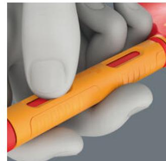
Die Aussparungen in der Freilaufhülse erlauben es, durch Fingerkraft einen Widerstand zu erzeugen. Dies ermöglicht es, die Ratschenmechanik auch bei geringem Schraubwiderstand zu nutzen.
